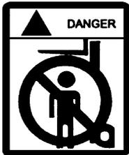
El área o zona de peligro para personas es aquella en la cual operan las carretillas, equipos adicionales (p.ej. de recogida de carga) o se encuentran las cargas. Aquí se incluye también el área que puede alcanzar el material cargado que pueda caer como la de otro tipo de dispositivo de trabajo.
