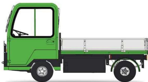
Transportador de 4 ruedas con plataforma. Con dispositivo "hombre presente" y tracción trasera. Extremadamente compacto y fácil de manejar, es ideal para todos los trabajos - tanto bajo techo como al aire libre, incluso para recorrer trayectos largos. El transportador PE20 viene preparado de fábrica para instalar numerosos equipos en la plataforma.
