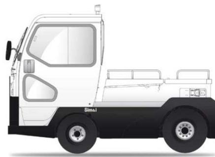
Tractor de 4 ruedas, con dispositivo "hombre presente" y tracción trasera. Es ideal para todos los trabajos intensivos - tanto bajo techo como al aire libre. Amplia plataforma trasera, con una capacidad de carga de 200 kg.
