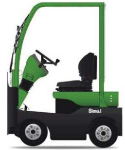
Tractor de 4 ruedas, con dispositivo "hombre presente" y tracción trasera. Extremadamente compacto y fácil de manejar, es ideal para todos los trabajos – tanto bajo techo como al aire libre e inclusive para trayectos largos. Plataforma trasera, con capacidad de carga de 100 kg.
