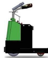
Tractor de 3 ruedas, con dispositivo "hombre presente" y tracción delantera. Extremadamente veloz, compacto y fácil de manejar, resulta ideal para transportar cargas pequeñas a corta distancia, por el interior de espacios industriales
