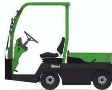
Tractor de 4 ruedas, con dispositivo "hombre presente" y tracción trasera. Extremadamente fácil de manejar, resulta ideal para todos los trabajos – tanto bajo techo como al aire libre. Es idóneo, en particular, para realizar los desplazamientos que requieren que el operador descienda con frecuencia a fin de efectuar las operaciones de enganche. Plataforma trasera con capacidad de carga de 100 kg.
