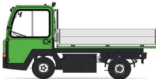
Transportador de 4 ruedas con plataforma. Con dispositivo "hombre presente" y tracción trasera. Extremadamente fácil de manejar, es ideal para todos los trabajos – tanto bajo techo como al aire libre, incluso para recorrer trayectos largos. El transportador PE30 viene preparado de fábrica para instalar numerosos equipos en la plataforma.
