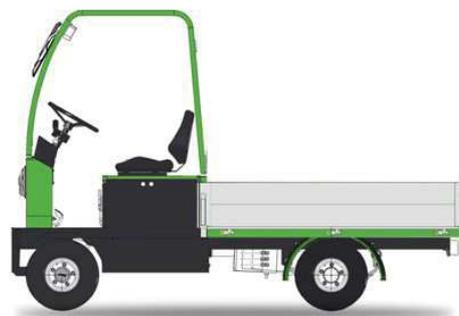
Transportador de 4 ruedas con plataforma. Con dispositivo "hombre presente" y tracción trasera. Extremadamente compacto y fácil de manejar, es ideal para todos los trabajos – tanto bajo techo como al aire libre, incluso para recorrer trayectos largos. El transportador PE15 viene preparado de fábrica para instalar numerosos equipos en la plataforma.
