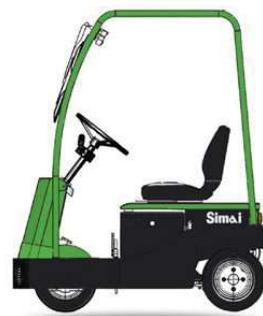
Tractor de 3 ruedas, con dispositivo "hombre presente" y tracción trasera. Extremadamente compacto y fácil de manejar es ideal para todos los trabajos industriales – también al aire libre. Altura con techo de protección: mínima, para pasar incluso por el interior de túneles o puertas bajos.
