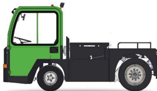
Tractor de 4 ruedas, con dispositivo "hombre presente". Posee tracción trasera para remolcar cargas pesadas. Potencia y autonomía: sumamente elevadas. Amplia plataforma trasera con capacidad de carga de 200 kg.
